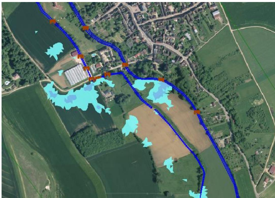
Figure 47 : débordement pour  $0,7 \text{ m}^3/\text{s}$  dans le Ru de Cérilly et  $3 \text{ m}^3/\text{s}$  dans le fossé de Tiremont
